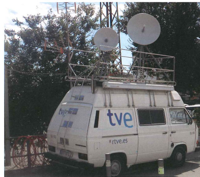
Figura 1.15. Instalación de telecomunicación en un vehículo móvil (tipo E).
